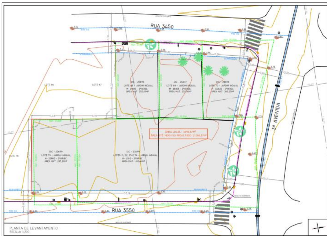
Figura 20: Levantamento topográfico planialtimétrico. Fonte: Levantamento Topográfico Planialtimétrico, 2024.
